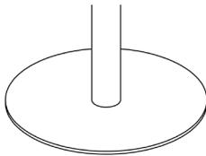
Acier noir, revêtement époxy. Equipé de protections de sol en feutre. Dimensions et épaisseur selon le plateau : épaisseur 6 mm et Ø35 cm pour les plateaux jusqu'à Ø50 cm. Epaisseur 8 mm et Ø52 cm pour les plateaux supérieurs à Ø50 cm ou 80x80 cm.
